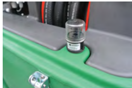
Sensor de control del espacio intersticial. Sensor de controle espacial intersticial.
